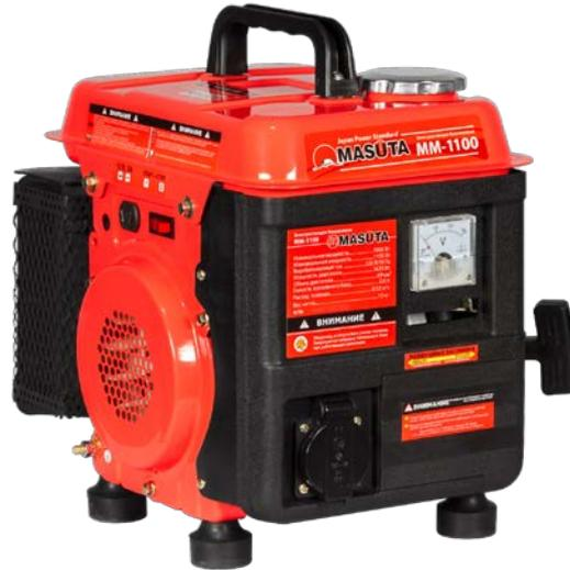
На инверторном генераторе MM-1100 используется двухтактный двигатель объемом 69 см<sup>3</sup>. В двухтактном двигателе моторное масло необходимо добавлять в бензин в пропорции 1:50 (топливная смесь: на 1 литр бензина добавляется 20 грамм масла).
