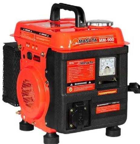
На инверторном генераторе MM-900 используется двухтактный двигатель объемом 63 см<sup>3</sup>. В двухтактном двигателе моторное масло необходимо добавлять в бензин в пропорции 1:50 (топливная смесь: на 1 литр бензина добавляется 20 грамм масла).
